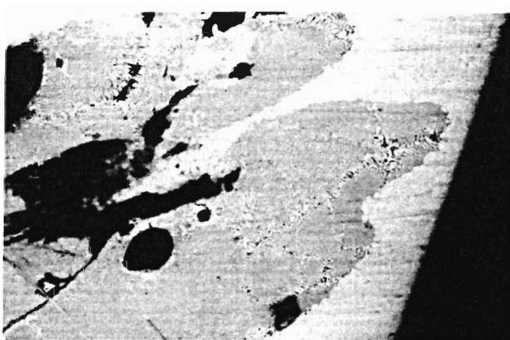
Figura 2.—Estructura metalográfica del denario republicano. Banda de formación de eutéctico plata-cobre. 250X
