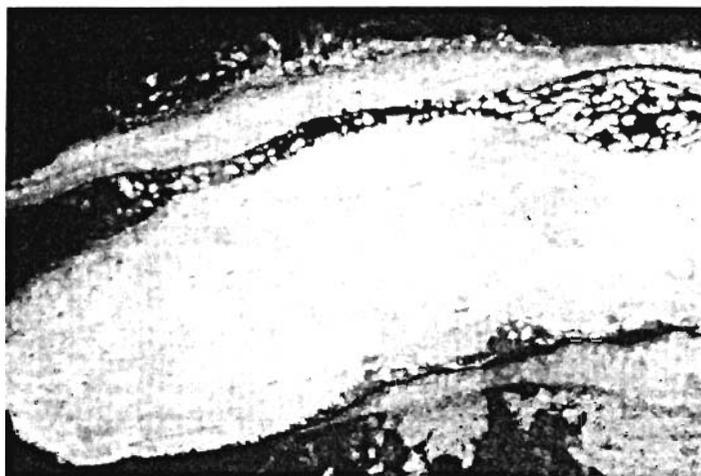
Figura 19.—Corte metalográfico del denario ibérico de la ceca de Bolskan. Estructura de granos de sección poligonal maclados en el forro de plata, aunque de menor tamaño que en el denario romano (compárese con la fig. 13). El esfuerzo de la acuñación ha propiciado la evolución de grietas por corrosión bajo tensión, cuyo pronóstico es la pérdida de parte de forro por desescamación. 160X
