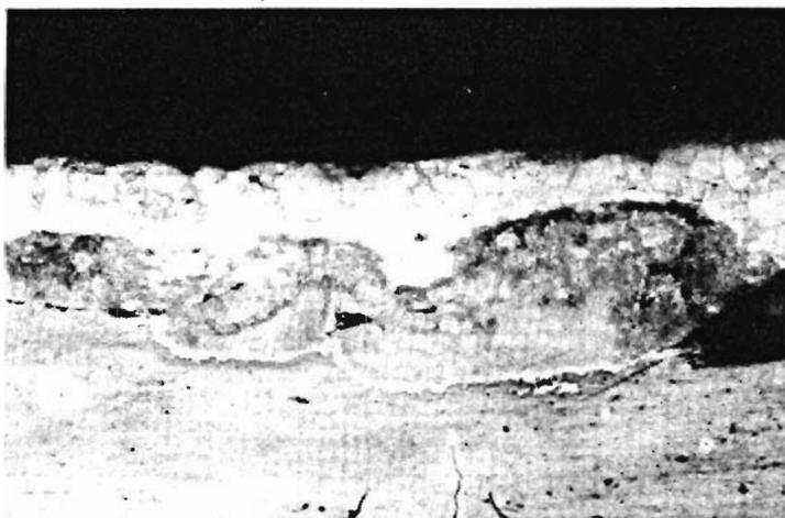
*Figura 13.—Estructura metalográfica del forro de plata del denario republicano. Véase explicación en el texto. 160X*
